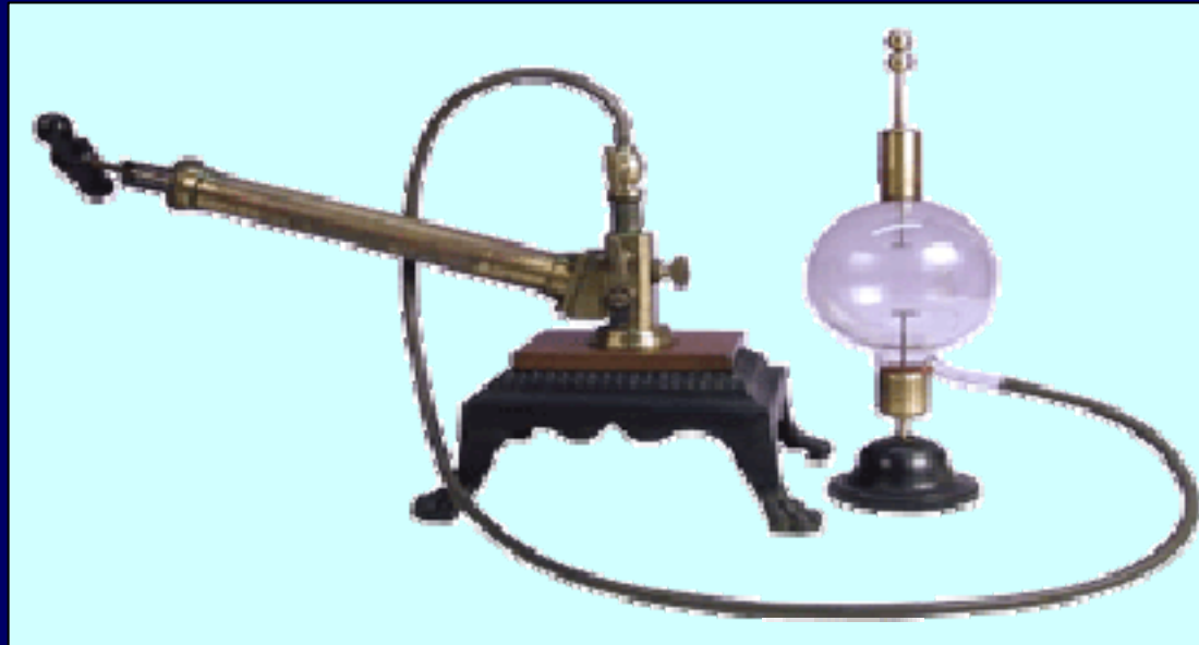
Célula de Descarga y Bomba de Vacío (1880)
