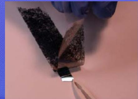
Luego hay que despegar el material de la cinta sobre un sustrato apropiado, que idealmente suele ser una capa de 300 nm de  $\text{SiO}_2$  sobre silicio. Con un simple microscopio óptico, se produce entonces el contraste adecuado para observar láminas de un solo átomo de grosor, entre un conjunto de fragmentos de diferente espesor.
